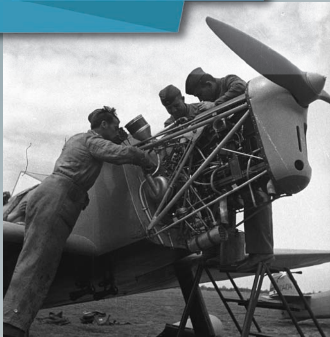
Први клијни мотори који су ремонтовани у ВР 166 били су типова „Валтер минор” и „ДХ Цијси мајор” коришћени на домаћим авионима „аеро-2” (МЦ „Одбрана”)
